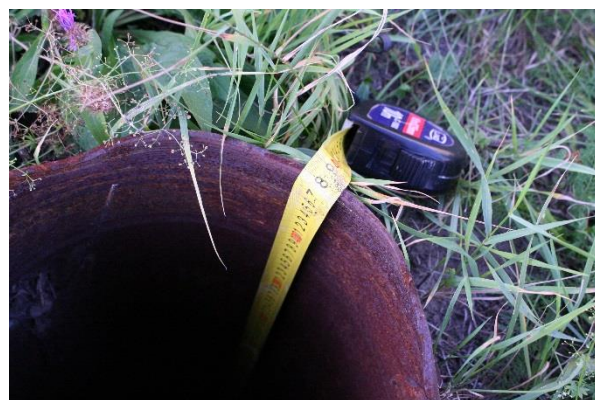
Hloubka vrtu je 4,03 m (dno vrtu – úroveň terénu). Ve vrtu se nevyskytuje voda.
