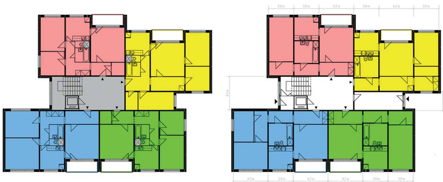
Běžné podlaží bodového domu OP 1.11 a první podlaží domů s bezbariérovou úpravou
